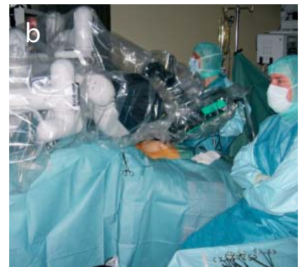
Abb. 1a: Die «daVinci»-Technik besteht aus einer Arbeitskonsole (Vordergrund) und dem Roboterstativ (Hintergrund). Das Stativ hält die Kamera und zwei bis drei Instrumentenarme. Der Chirurg führt die Instrumente von der Konsole mit dreidimensionaler Sicht und voller Bewegungsfreiheit. 1b: Der Roboter ist an die laparoskopischen Zugänge gekoppelt. Die Instrumente haben eine vollständige Bewegungsfreiheit.
